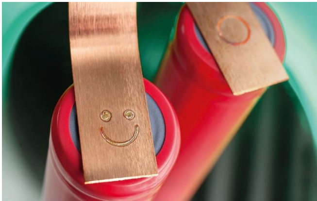
Bild 1: Ein Thema beim LSE'20: Effizientes Laserstrahl- schweißen für die Kontaktierung von Batterien. © Fraunhofer ILT, Aachen.
